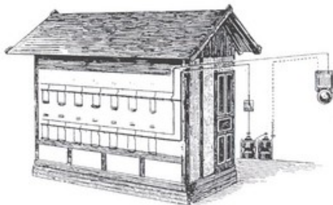
Elektrischer Schwarmmelder aus dem Jahre 1911
